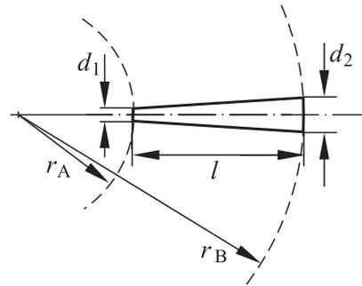
⚠ Bei dieser Aufgabe liegt es nahe, die Lösung dadurch zu vereinfachen, dass man den Widerstand eines Zylinders mit dem mittleren Durchmesser  $7 \text{ mm}$  berechnet (s. Aufgabe 1.11). Lassen Sie sich nicht auf diesen Irrweg locken, der zu einer falschen Lösung führt.
