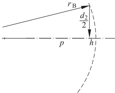
Die Höhe  $h$  der Kugelkappe beim Radius  $r_B$  berechnen wir mit  $r_B = p + h$  und  $p^2 + (d_2/2)^2 = r_B^2$ :
