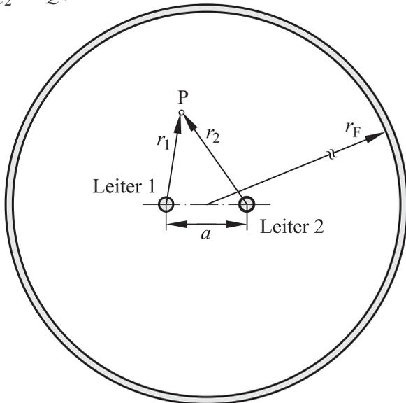
4) Welches Potenzial  $\varphi_{L1}$  hat der Punkt P für  $Q_1 = +Q$  und  $Q_2 = -Q$ , wenn er auf der Oberfläche des Leiters 1 liegt, wo  $r_1 = r_L$  und  $r_2 \approx a$  ist?
