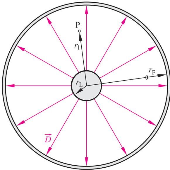
2) Im Folgenden trage lediglich der Leiter 2, den wir koaxial zum Fernzylinder angeordnet annehmen, die Ladung  $Q_2$ . Welches Potenzial  $\varphi_2$  hat der Punkt P im Abstand  $r_2$  von der Achse?
